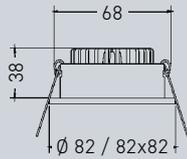
**Einbaustrahler** – Aluminium, Glas klar, schwenkbar, ohne Konverter, dimmbar mit geeignetem Konverter, Ø 82 mm, H. 38 mm, Deckenausschnitt 68 mm, 7 W, 740 lm, 3000 K
