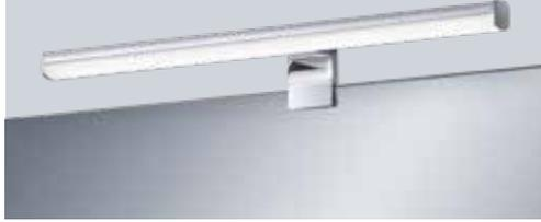
**Klemmleuchte** – nickel satiniert/chrom, schwenkbar 350°, drehbar 100°, mit Schalter, B. 60 mm, H. 110 mm, Ausl. 150 mm, 5,5 W, GU10, (Leuchtmittel nicht inkl.)
