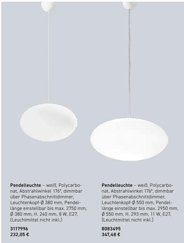
**Pendelleuchte** – weiß, Polycarbonat, Abstrahlwinkel 176°, dimmbar über Phasenabschnittdimmer, Leuchtenkopf-Ø 380 mm, Pendellänge einstellbar bis max. 2750 mm, Ø 380 mm, H. 240 mm, 8 W, E27, (Leuchtmittel nicht inkl.)
